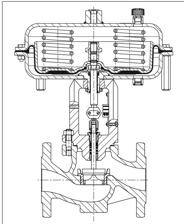
**Bild 1:** Stellventil Typ 3241-1 · NPS ½ bis 6
