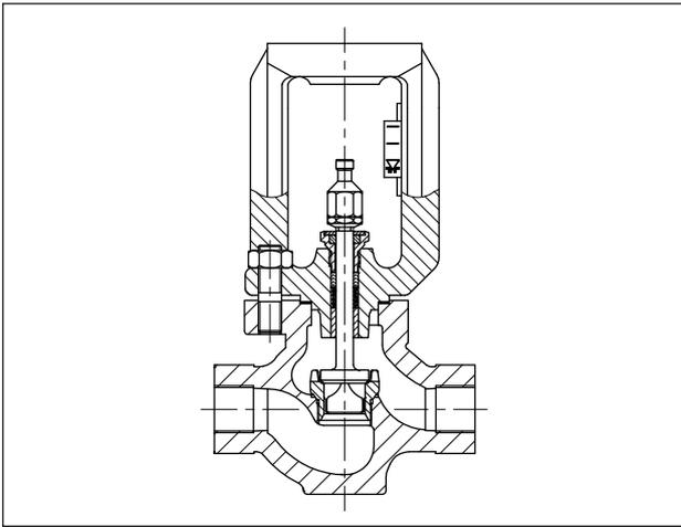
**Bild 4:** Ventil Typ 3241 mit NPT-Gewinde · ½ bis 2 NPT
