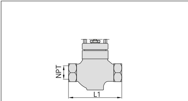
**Bild 8:** Typ 3241 mit Gewindeanschluss ½ bis 2 NPT
