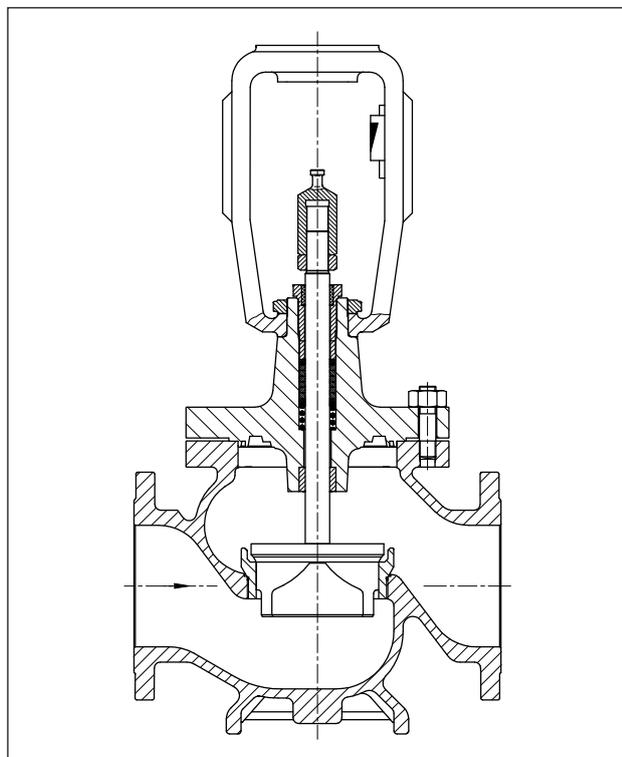
**Bild 2:** Ventil Typ 3241 · NPS 8 bis 12
