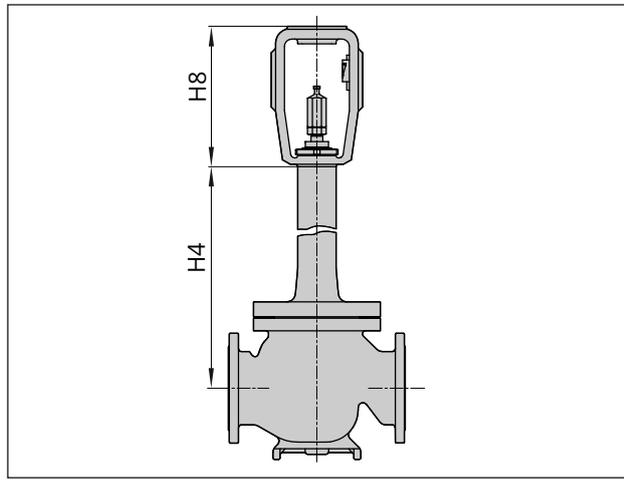
**Bild 10:** Typ 3241 mit Isolier-/Balgteil ab Nennweite DN 200/NPS 8
