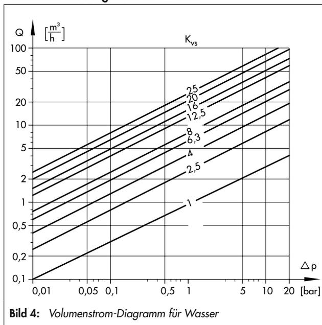
**Bild 4: Volumenstrom-Diagramm für Wasser**
