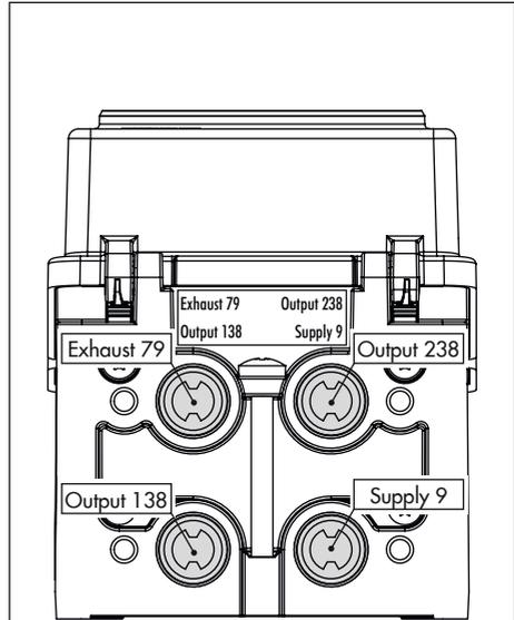
Bild 5-23: Pneumatische Ausgänge
