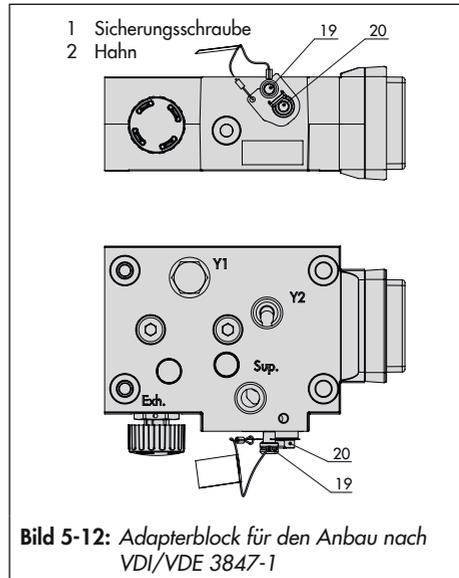
Bild 5-12: Adapterblock für den Anbau nach VDI/VDE 3847-1
