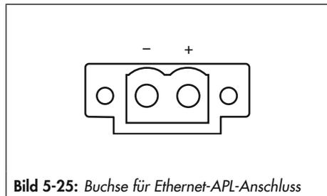
**Bild 5-25:** Buchse für Ethernet-APL-Anschluss
