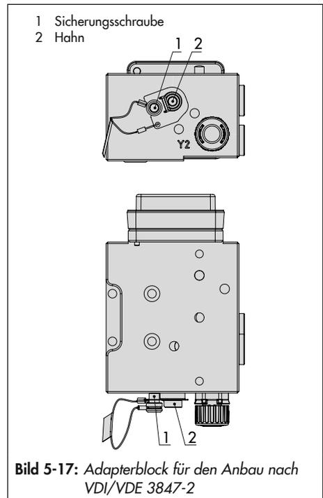
**Bild 5-17:** Adapterblock für den Anbau nach VDI/VDE 3847-2
