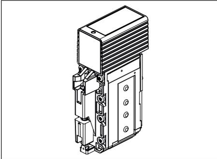
Bei seiner Auslieferung ist der Stellungsregler bereits mit den Pneumatikmodulen bestückt.
