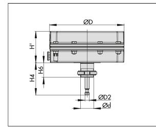
**Fig. 7:** *Type* 3271-5 · 120 cm<sup>2</sup> actuator area
